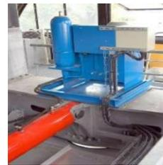
液压张紧系统作用于张紧大轮上，以便确保主钢丝绳和大轮橡胶轮衬间的安全摩擦系数。液压油缸行程 4 米，那个满足张紧需求。
