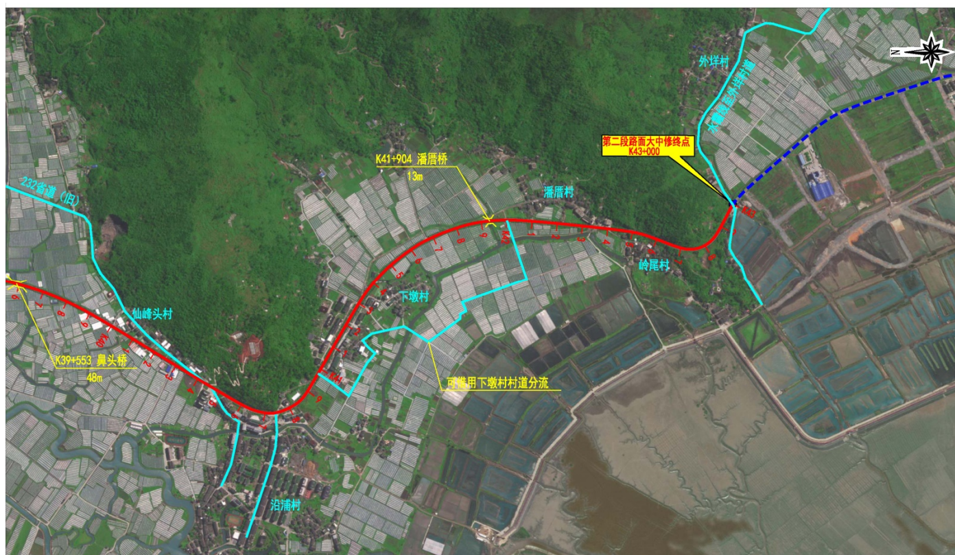
图 8-3 K41+500~K43+000 段临时施工期交通组织
