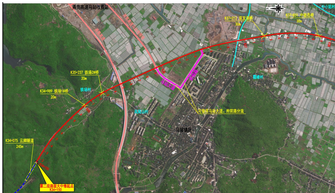
图 8-1 K34+150~K38+000 段临时施工期交通组织
