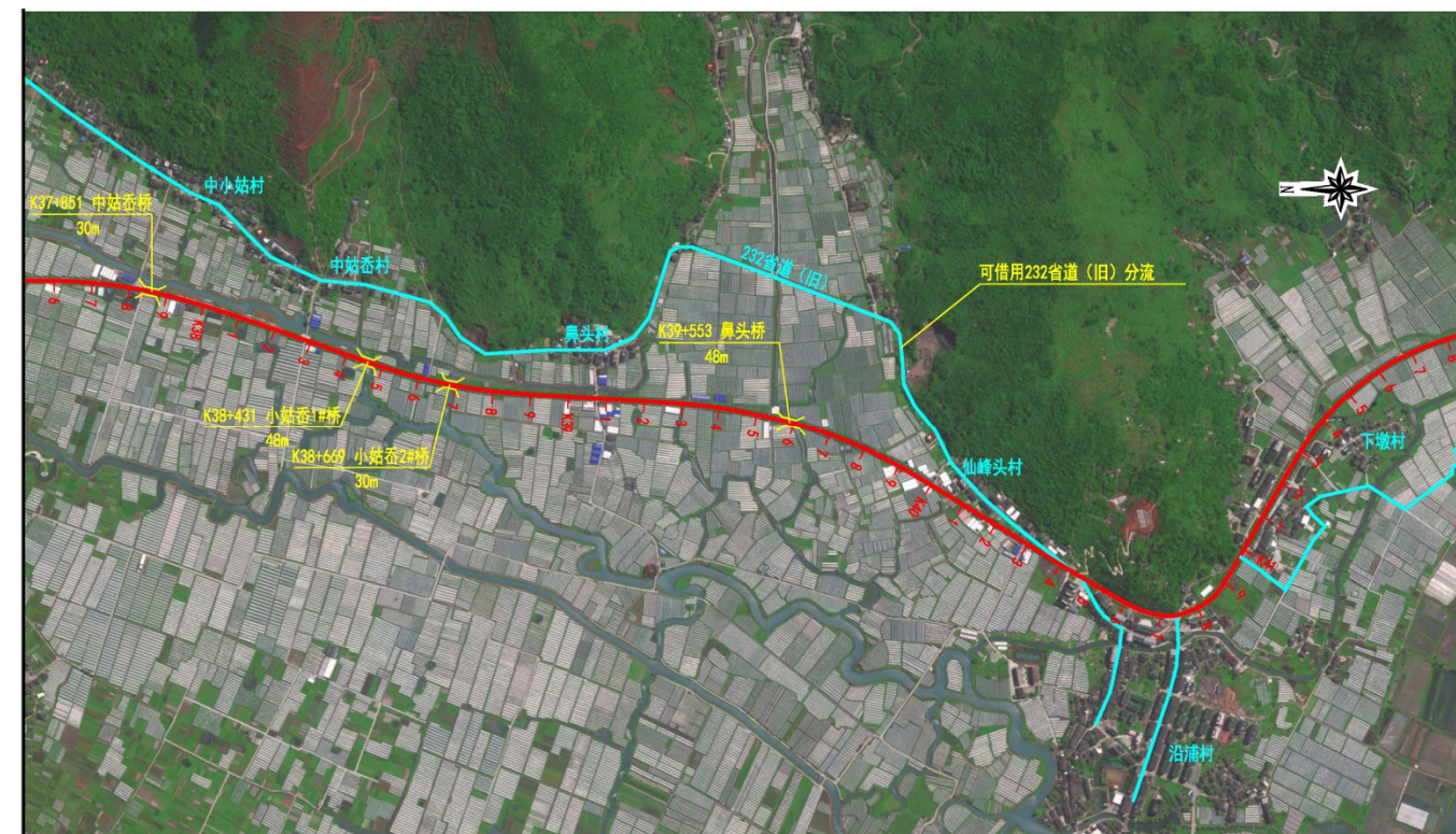
图 8-2 K38+000~K41+500 段临时施工期交通组织
